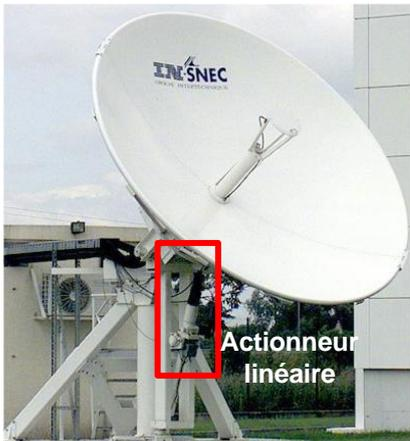
L'actionneur SNT VL 20 est un vérin électrique dédié au mouvement linéaire en général et au positionnement en particulier. Offrant silence, précision, sécurité et fiabilité, il est parfaitement adapté aux utilisations en milieux exigeants tels que :
