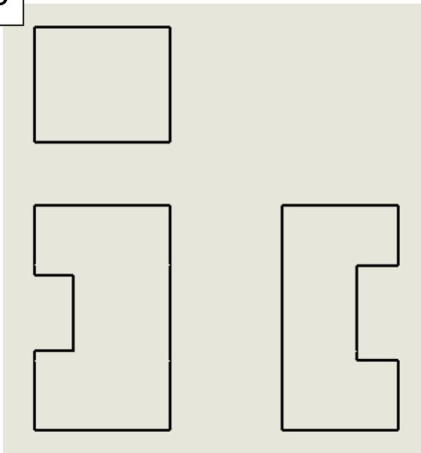
**Réaliser** en respectant les règles de dessin et l'échelle le dessin de définition du taquet (vue de dessus et vue de droite).
